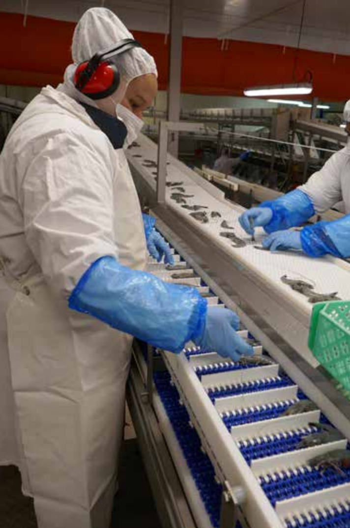
Les crevettes sont placées une à une dans une goulotte où elles sont pesées au gramme près.
